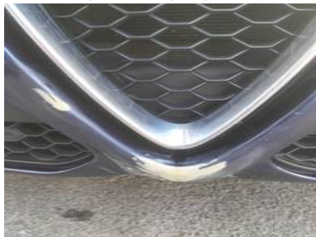
Calandre (Défaut aspect)
